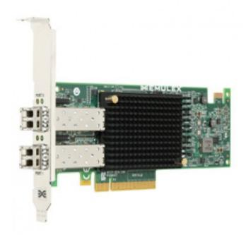
Architektura 10GbE Złącze LC (MM) Okablowanie MMF do 300m Ilość portów Typ złącza magistrali PCI Express 3.0 x8 Format Low Profile XE100 Chipset Technologie SR-IOV iSCSI HW offload Tak FCoE HW offload Tak FCoE Tak
