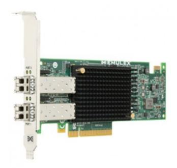
Architektura 10GbE Złącze LC (MM) Okablowanie MMF do 300m Ilość portów Typ złącza magistrali PCI Express 3.0 x8 Format Low Profile XE100 Chipset Technologie SR-IOV iSCSI HW offload Tak
